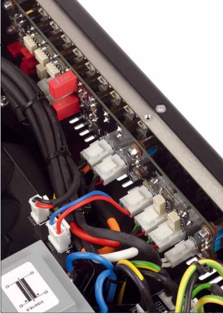
Audiosignale werden direkt am Ort des Geschehens per Relais geschaltet
