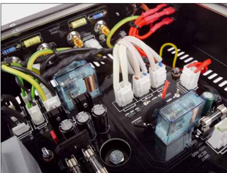
Die großen Relais dienen dem Einschalten der Betriebsspannungen in der richtigen Reihenfolge
